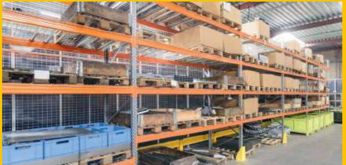
Rayonnage Epirack dédié aux charges lourdes palettisées.
